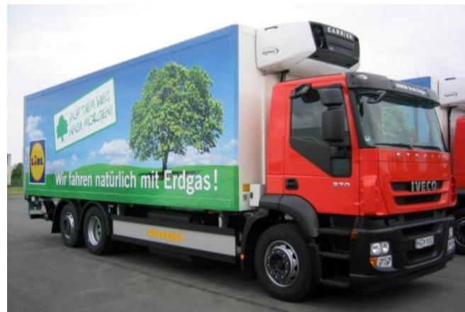
IVECO CNG truck
